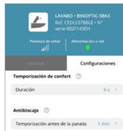
También se puede ajustar la **temporización de confort** (retraso del cierre del grifo una vez que se retiran las manos o el cuerpo del detector de infrarrojos).
